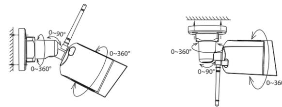
Orientez la caméra dans la position souhaitée et fixez-la avec les vis de montage fournies.
