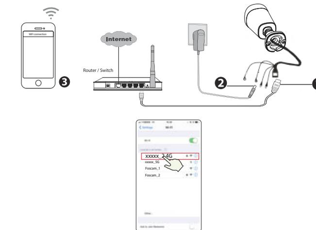
**Attention :** vous devez vous connecter à un réseau Wifi 2.4GHz si votre routeur Wifi est dual-bande. La plupart des nouveaux routeurs ont les deux réseaux 2.4GHz et 5GHz. Par exemple, choisissez SSID : XXXXX\_2.4G.
